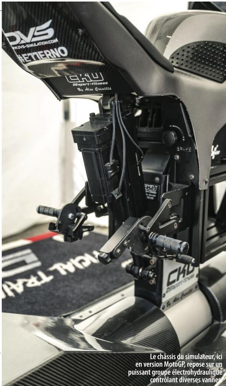
Le châssis du simulateur, ici en version MotoGP, repose sur un puissant groupe électrohydraulique contrôlant diverses vannes
