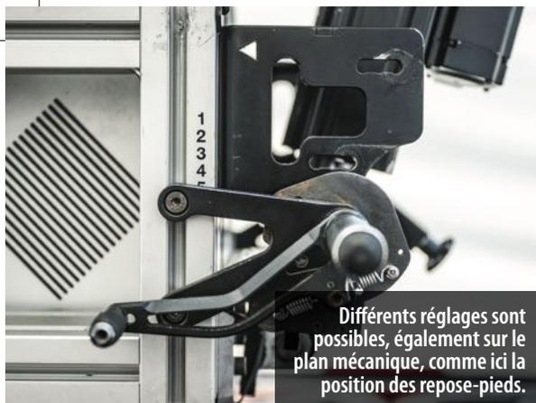
Différents réglages sont possibles, également sur le plan mécanique, comme ici la position des repose-pieds.
